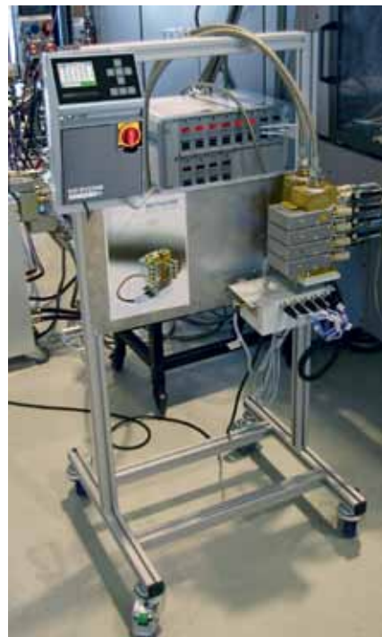
▲ Versuchsanordnung mit Durchflussmesser Flow-5 (autonom): Über das zentrale Bedienungsmodul werden hier vier Temperierkreisläufe gemeinsam überwacht.
