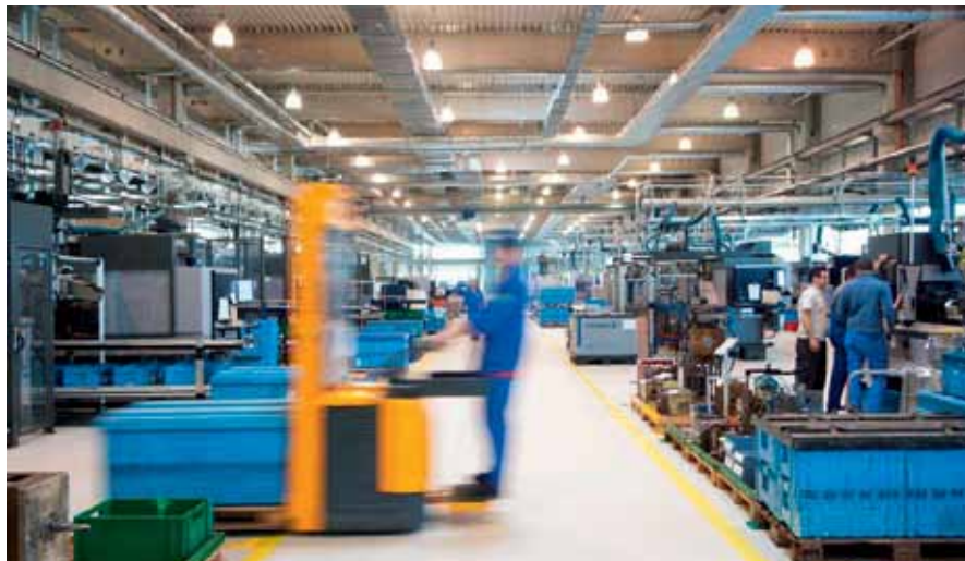
▲ Ensinger Werkshalle: Ein Blick in den Produktionsbereich zeigt, dass hier Abläufe optimal geplant und nachgeordnet baulich umgesetzt werden konnten. Material- und Medienversorgung erfolgen zentral.
