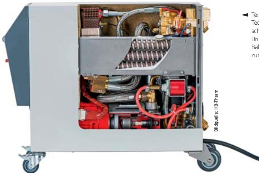
◀ Temperiergerät neuester Technologie mit vollständig geschlossenem Kreislauf und aktiver Drucküberlagerung wie sie bei Balda Medical in Bad Oeynhausen zum Einsatz kommen.
